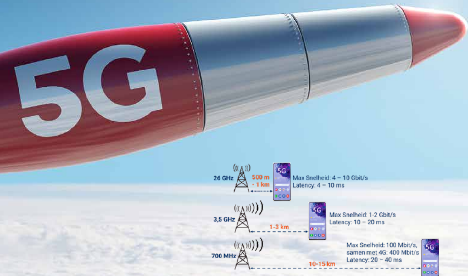
Afbeelding 2: 5G is in Europa beschikbaar op 3 banden: 700 MHz, 3,5 GHz en 26 GHz. De 700 MHz band is vooral bedoeld om 5G dekking te realiseren, de 3,5 GHz band kan veel capaciteit bieden en de 5G topsnelheden komen via de 26 GHz band. Je kunt het zien als een gelaagde taart, waarbij we eerst de onderste laag hebben gekregen, we nu de tussenlaag krijgen terwijl het lekkerste nog moet komen.
